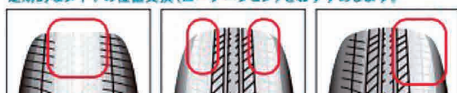
センター摩耗 (空気圧過剰による) ショルダー摩耗 (空気圧不足による) 片減り (ミニバンなどの重い車に多い)
